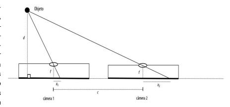
Certo objeto está a uma distância d do plano de imagens das câmeras (o plano que contém os sensores). Na imagem da câmera 1 (a da esquerda), o objeto aparece localizado em um pixel à direita do centro da imagem e a uma distância  $x_1$  deste centro. Já na imagem da câmera 2 (da direita), o objeto aparece localizado em um pixel também à direita do centro da imagem e a uma distância  $x_1$  deste centro, como mostra a figura.
